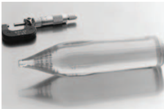
Figure 1 – Boule d'un monocristal de grenat YAG dopé par l'ion Nd^{3+} dans laquelle seront extraits les barreaux et les plaquettes laser
