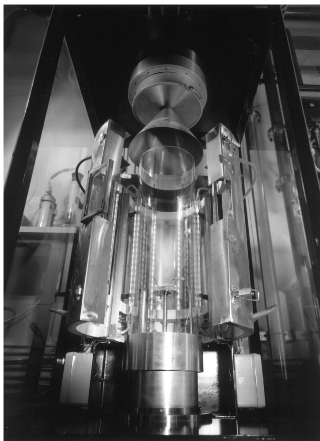
Figure 11 – Photographie du calorimètre de Tewarson (appareil ouvert) (cliché le Square des photographes)
